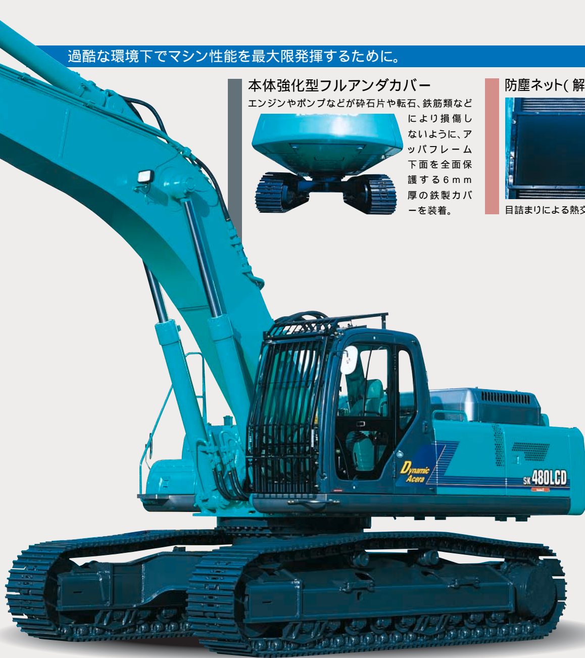
写真:解体仕様
