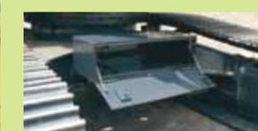
日常整備や作業機脱着に必要な工具・部品を収納可能。（PC350LCのみ設定）
