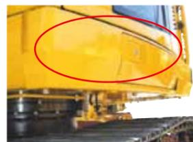
鉄筋などの突き上げに配慮して外装を強化しています。
