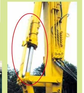
接触などによるシリンダ破損を防ぐため、バケットシリンダガードを装備。
